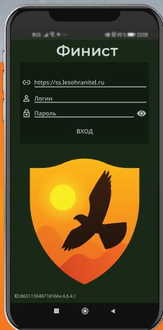
Мобильное приложение управления БПЛА – Модуль «ФИНЕСТ» - имеет несколько режимов, в том числе передача данных онлайн в центральную систему. Позволяет определять пути подъезда к пожару, площадь пожара, кромку пожара, склеивать ортофотопланы, привязывать данные об обследовании к событию и т.д.
